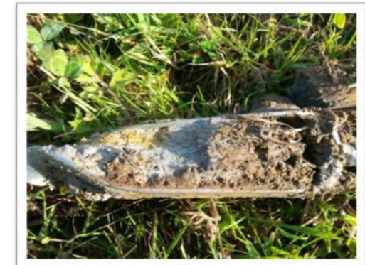
Figure 492 : Exemples de carottes avec des traits rédoxiques (à gauche) et des traits réductiques (à droite)
